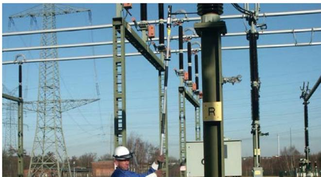
Abstands-Spannungsprüfer ASP in einer Freiluftschaltanlage.
