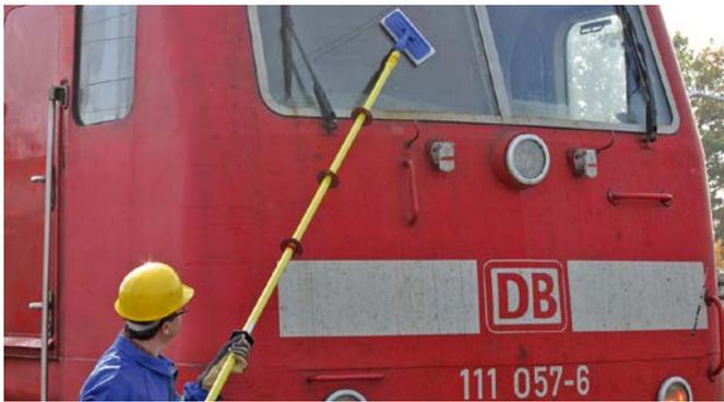
Scheibenreinigung einer E-Lokomotive mit dem Isolierstangen-Set.
