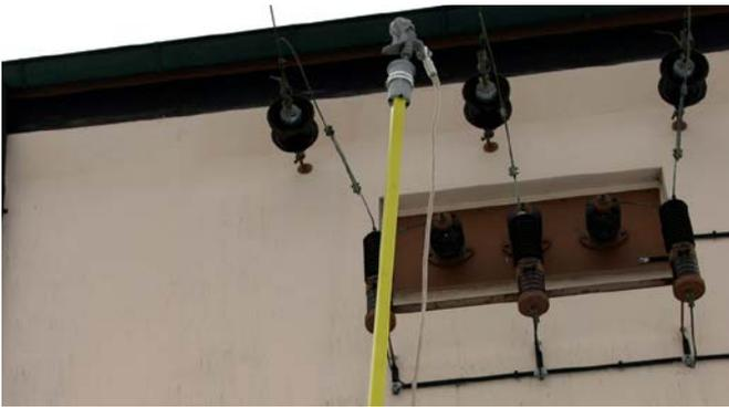
Teleskop-Erdungsstange mit Alu-Trichterkupplung und Phasenschraubklemme.
