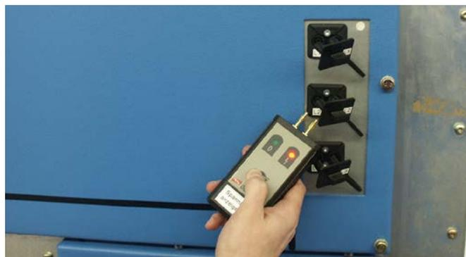
Eigenprüfung des Spannungsanzeigerätes DEHNcap/A.
