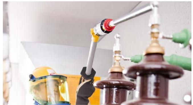
Prüfkopf PHE III mit Universalzahnkupplung und Isolierstange.
