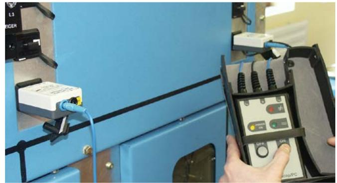
Einsatz des Phasenvergleichlers DEHNcap/PC-LRM mit zwei HR-LRM-Messadaptern an einer HR-Schaltanlage.
