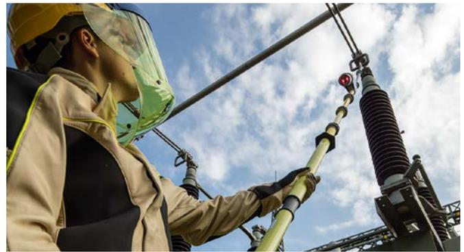
Spannungsprüfer PHE4 an einer Freiluftstation 110 kV.
