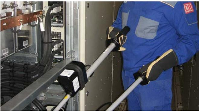
Gleichspannungsprüfer PHE/G II für Gleichstromzwischenkreise (ICE-Triebkopf).
