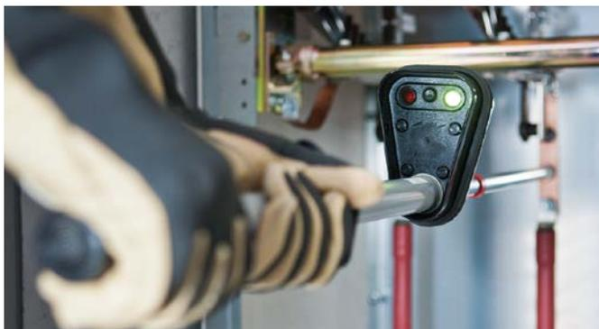
Spannungsprüfer PHE mit optischer Anzeige.
