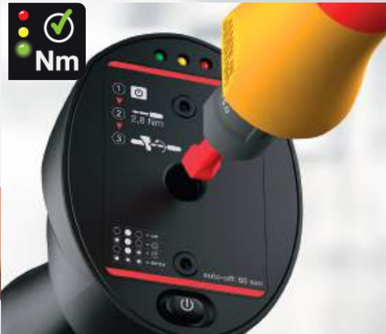
Egyszerű ellenőrzés a jelzőlámpa szimbólumaival
